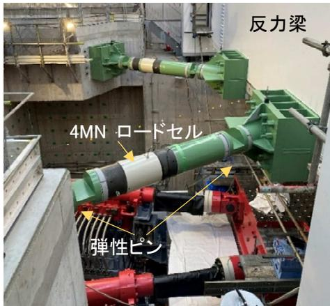
(a) V型に配置された荷重計測リンク
